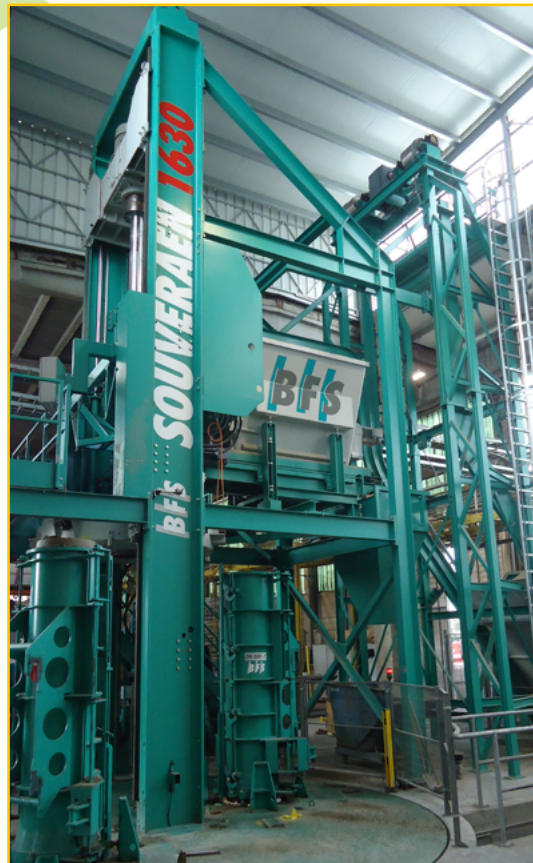
Foto 1 : BFS ' rollerhead' Buizenmachine
